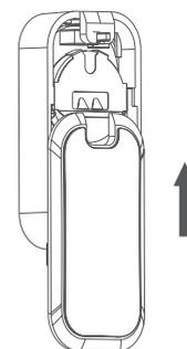
④ Depois de adicionar o sensor no aplicativo, retire o adesivo 3M e posicione o sensor no local desejado.
